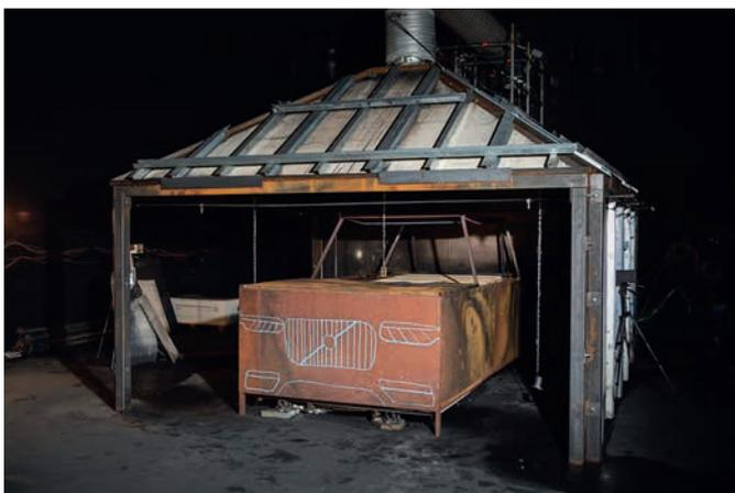
**Bild 4** Kalorimeter und Fahrzeugattrappe mit Ersatzbrandlast aus Holz
