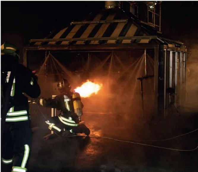
**Bild 5** Brandversuch mit Methanstrahlflamme und Wasserdampf
