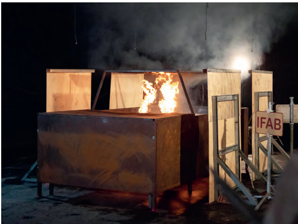
Bild 2 Fahrzeugatrappe mit Zielbrandlasten kurz nach der Zündung Dummy vehicle with target fire loads shortly after ignition
