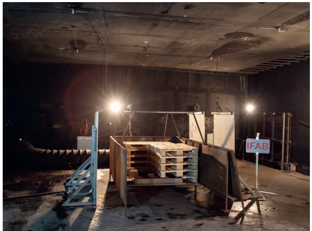
Bild 1 Versuchshalle mit der Fahrzeugatruppe während der Platzierung der Brennstoffe für die Ersatzbrandlast Testing hall with the dummy vehicle during the placement of the fuels for the replacement fire load
