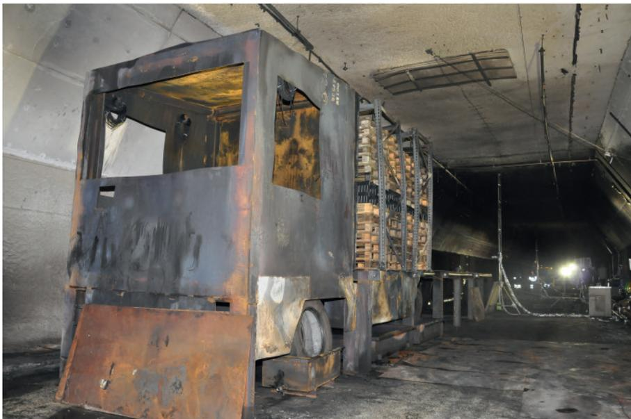
Abb. 2: Beispielhafte Ersatzbrandlast eines LKW
