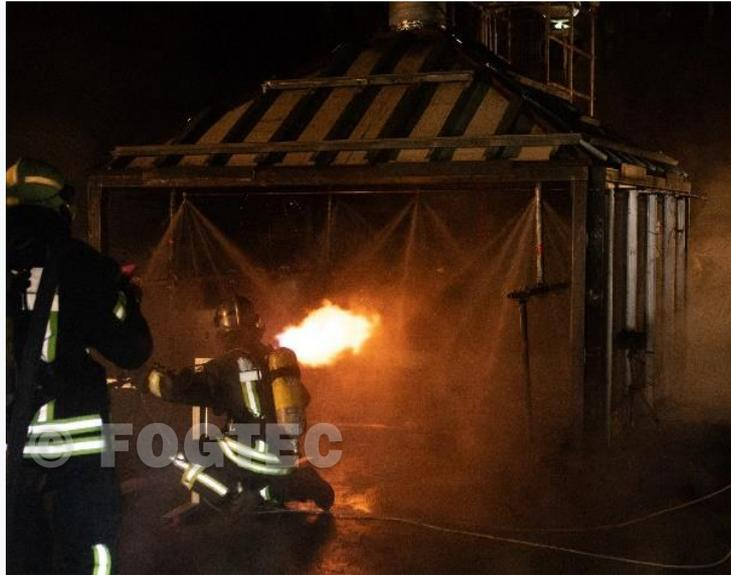
Brandversuche mit Lithium-Batterien in der SUVEREN-Testkammer
