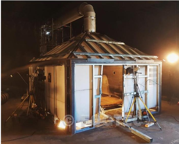
SUVEREN - Batterie-Brandprüfkammer (Kalorimeter)
