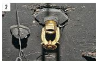
Aufnahmen verschiedener Systemteile, die in der zweiten Brandversuchsreihe verwendet wurden: Düse für gasförmige Brandbekämpfungsmittel (1), aktivierter Sprinklerkopf (2), verschiedene Detektoren (3).
