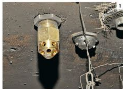
Aufnahmen verschiedener Systemteile, die in der zweiten Brandversuchsreihe verwendet wurden: Düse für gasförmige Brandbekämpfungsmittel (1), aktivierter Sprinklerkopf (2), verschiedene Detektoren (3).
