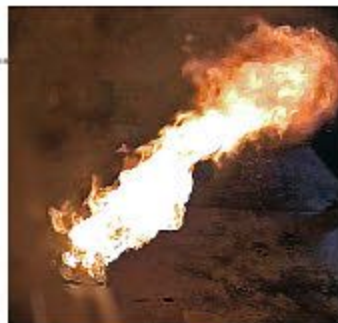
Eindrücke einer Batterie beim thermischen Durchgehen: abblasende Gase aus einer prismatischen Zelle, Länge der Strahlflamme ca. 1 m (Bild oben), Freisetzung der elektrischen Energie unter Funkenflug (Bild unten).
