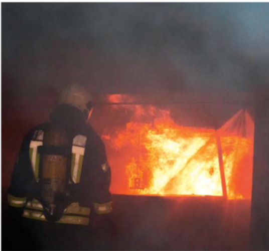
Bild 2: Brandversuch im realen Maßstab mit der Fahrzeugatruppe und dem Einsatz einer Wassernebel-Anlage. ©FOGTEC Brandschutz GmbH
