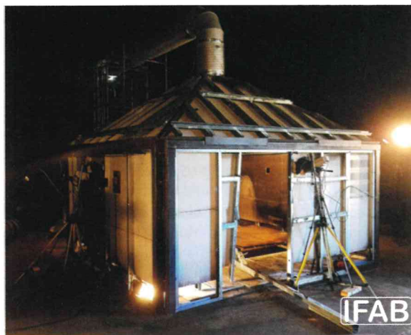
Bild 1. Versuchsstand Suveren-Kalorimeter zur Aufnahme und Erforschung des Brandverhaltens von Lithium-Ionen-Batterien
