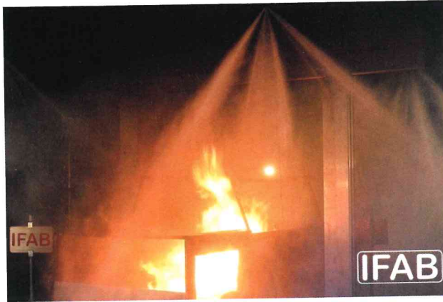
Bild 3. Momentaufnahme kurz nach der Aktivierung des Brandbekämpfungssystems. Durch den Einsatz einer Hochdruck-Wassernebelanlage kann ein Fahrzeugbrand kontrolliert und eingedämmt werden.
